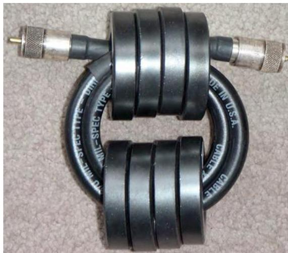
Balun mit RG213U von W1HIS -  $1\text{k}\Omega$  bei 1,8MHz u.  $550\Omega$  bei 28 MHz
