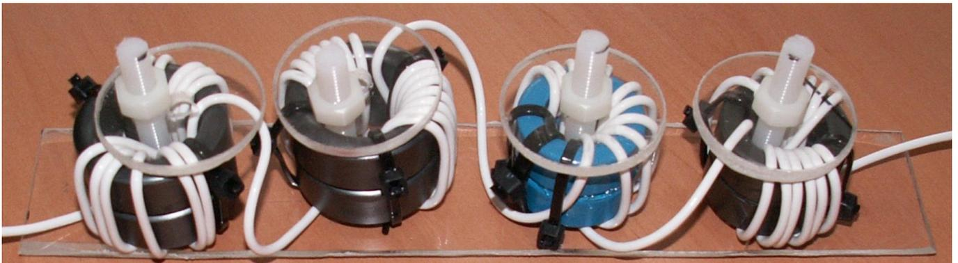
**Mantelwellensperre 1:1 (50Ω) in Reihenschaltung mit Teflonkoax RG188**
