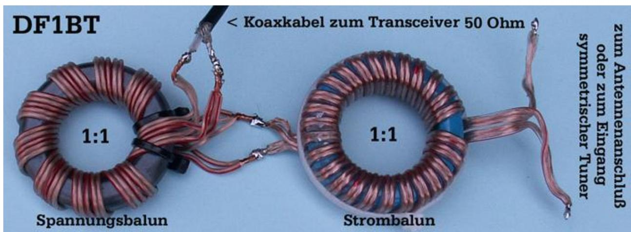
DF1BT Spannungsbalun in Serie mit einem DGØSA Strombalun
