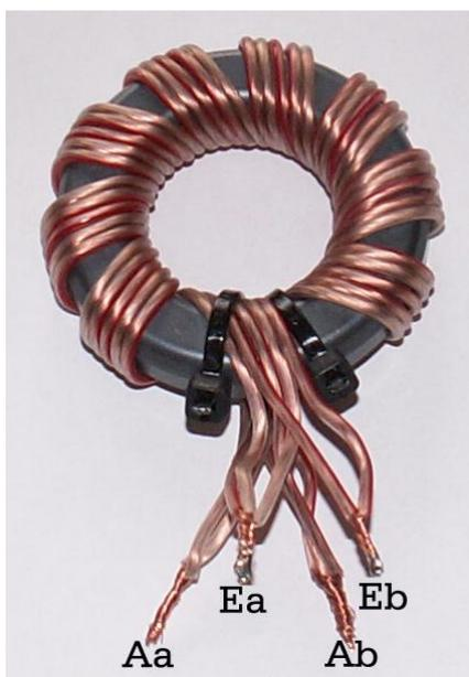
Wickelschema DF1BT Spannungsbalun
