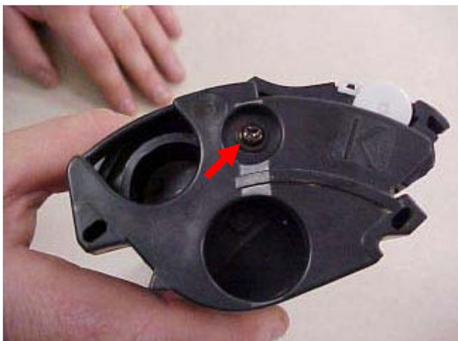
Mit Hilfe eines Schraubendrehers entfernen Sie die Schraube an der linken Seite der Kartusche. Nehmen Sie den Gehäusedeckel ab.
